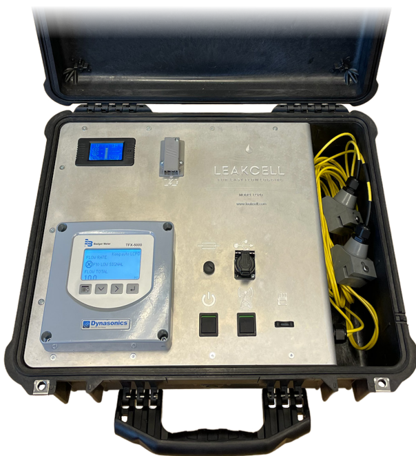
LEAKCELL LCPD, en bærbar ultralydflowmåler med opptil en ukes batterilevetid, koblet via mobilnett til nettportal eller til eget driftskontrollsystem for logging av vannflow
